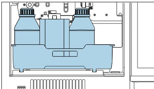
Снимите лоток для бутылей: слегка приподнимите утепленный захват и оттяните его вперед.
