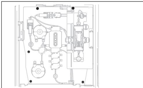
Выверните 5 винтов крепежной панели с помощью отвертки под винты Torx (T25).
