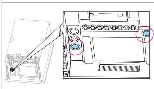
Пропустите подогреваемый сливной шланг (слева на рисунке) и подогреваемый шланг для подачи пробы (справа на рисунке) через указанные кабельные уплотнения.
